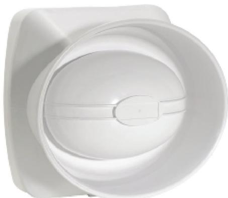
Le diffuseur sonore conventionnel est un dispositif d'alarme qui s'intègre dans les systèmes de détection et d'alarme incendie. Il est utilisé pour avertir les occupants d'un bâtiment de la présence d'un risque d'incendie. Il diffuse le son NF S 32 001. Les diffuseurs sonores doivent être audibles de tous les points du bâtiment où ils sont installés.
