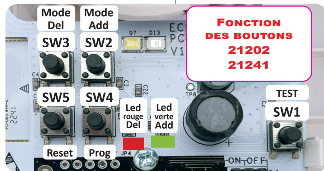
**SW1** : fonction d'autotest, **SW2** : «Add» = appairage, **SW3** : «Del» = désappairage, **SW4** : «Prog» = programmation périphériques, **SW5** : «Reset» = retour aux réglages d'usine
